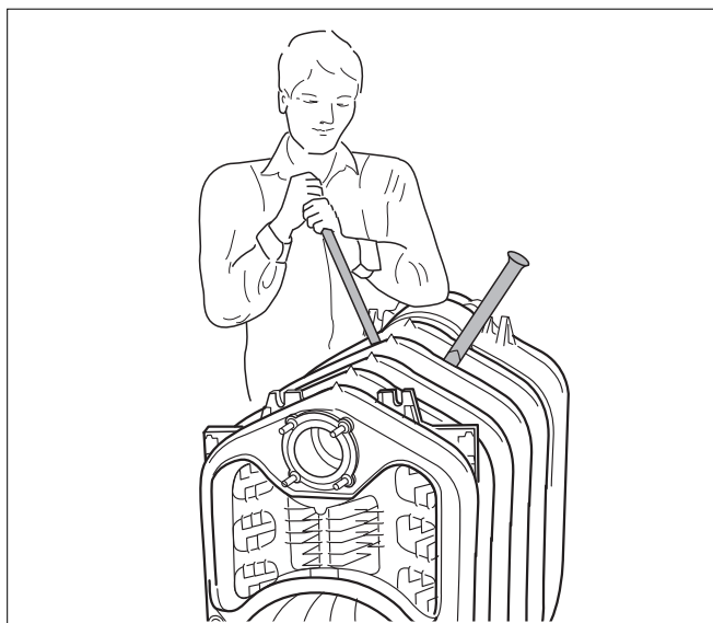
Рис. 26 Разъединение секций котла
